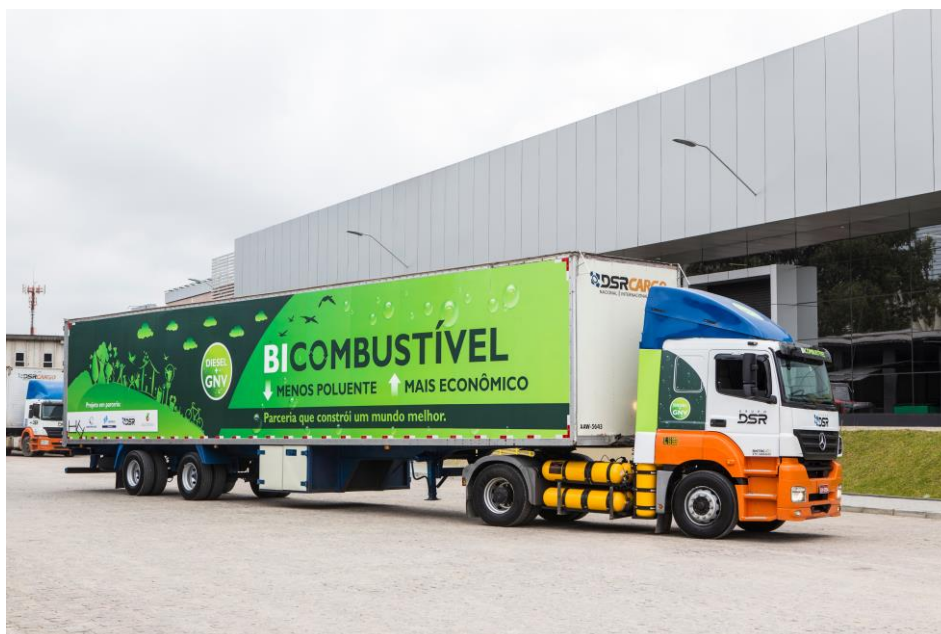
Figura 51. Caminhão Bicombustível Dual Fuel Fonte: COMPAGAS
