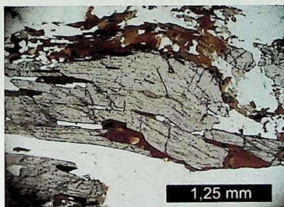
1050 - Cianita com dobrada em alta temperatura. Nicóis paralelos.
