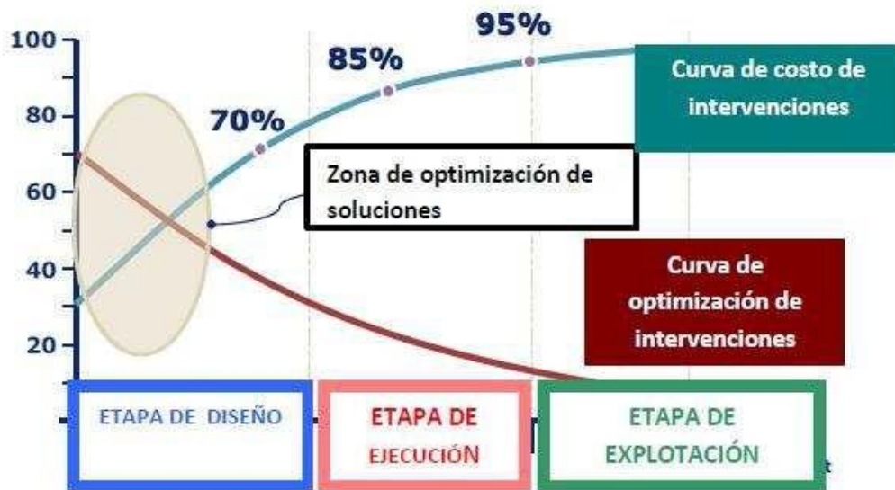
Figura 1- Etapas de proyectos de construcción
