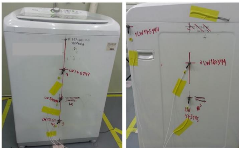
Figura 10 – Acelerômetros fixados no painel frontal (esquerda) e no painel lateral (direita). [5]
