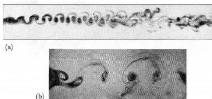
Figura 2.7 – Transição na esteira. (a) Re=180 (b) Re=340 . Adaptado de Zdravkovich (1997).
