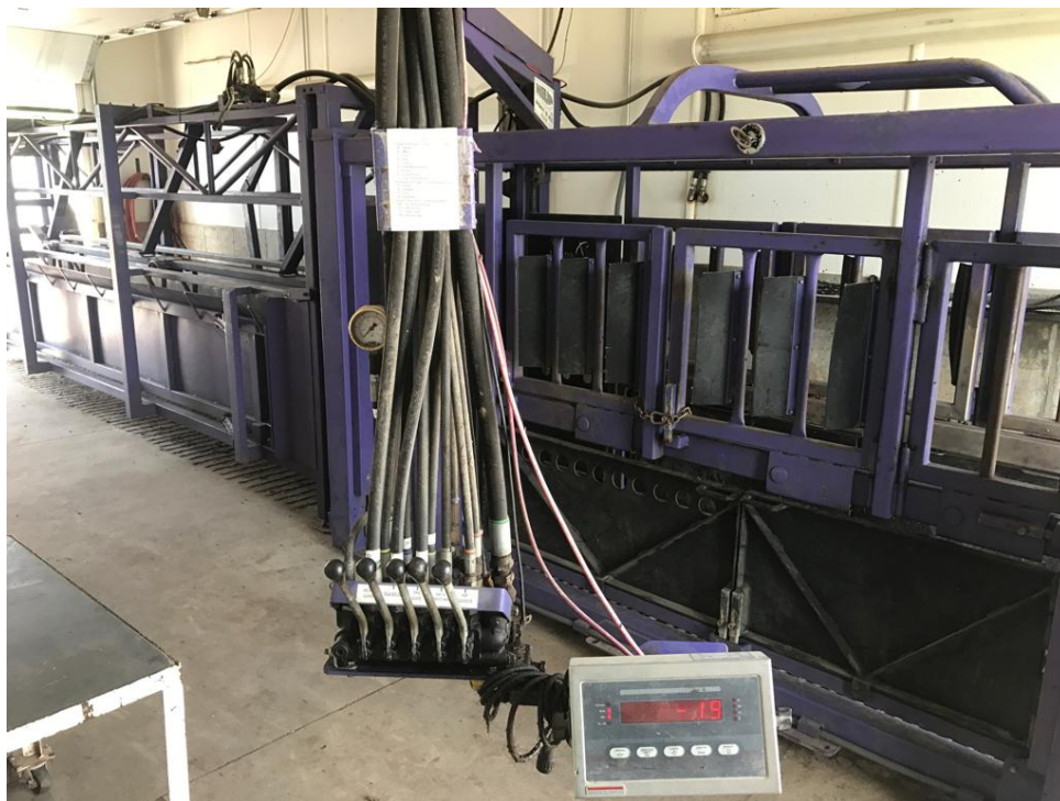
Figura 9 Tronco hidráulico utilizado para pesagem inicial dos animais Fonte: (Gabriel Zylberlicht, 2017)
