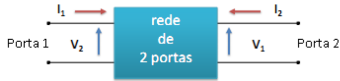
Figura 5 – Portas, correntes e tensões utilizadas no conceito de quadripolo [10]
