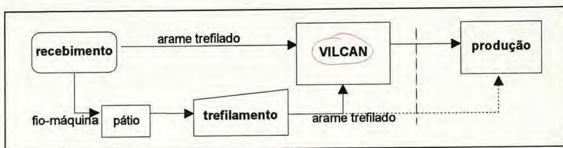
Figura 14 - Fluxograma do Caminho da Matéria-Prima
