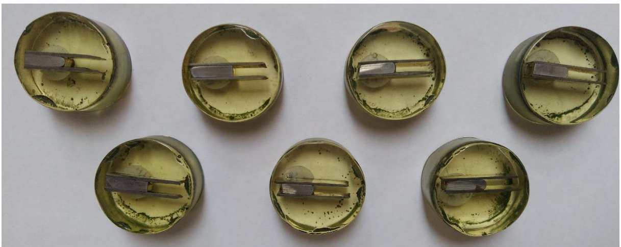
Figura 8: Duas amostras de cada lote de lâminas embutidas em resina.
