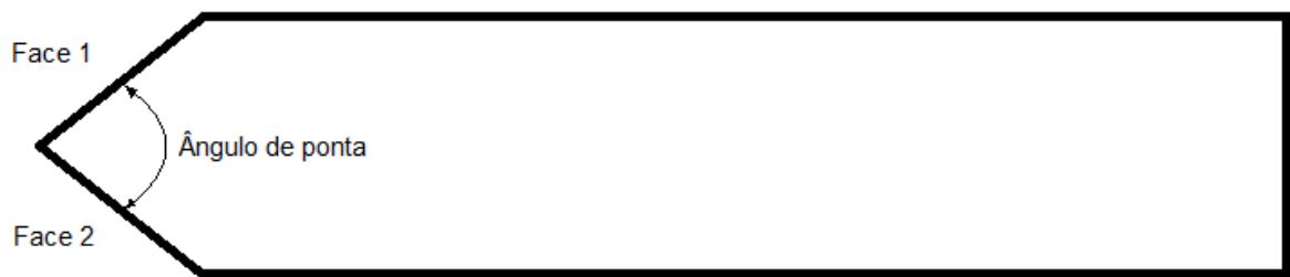
Figura 11: Esquema da seção transversal de uma lâmina, ilustrando as duas faces que formam o ângulo de ponta. Fonte: Francisco Pereira Netto, 2016.
