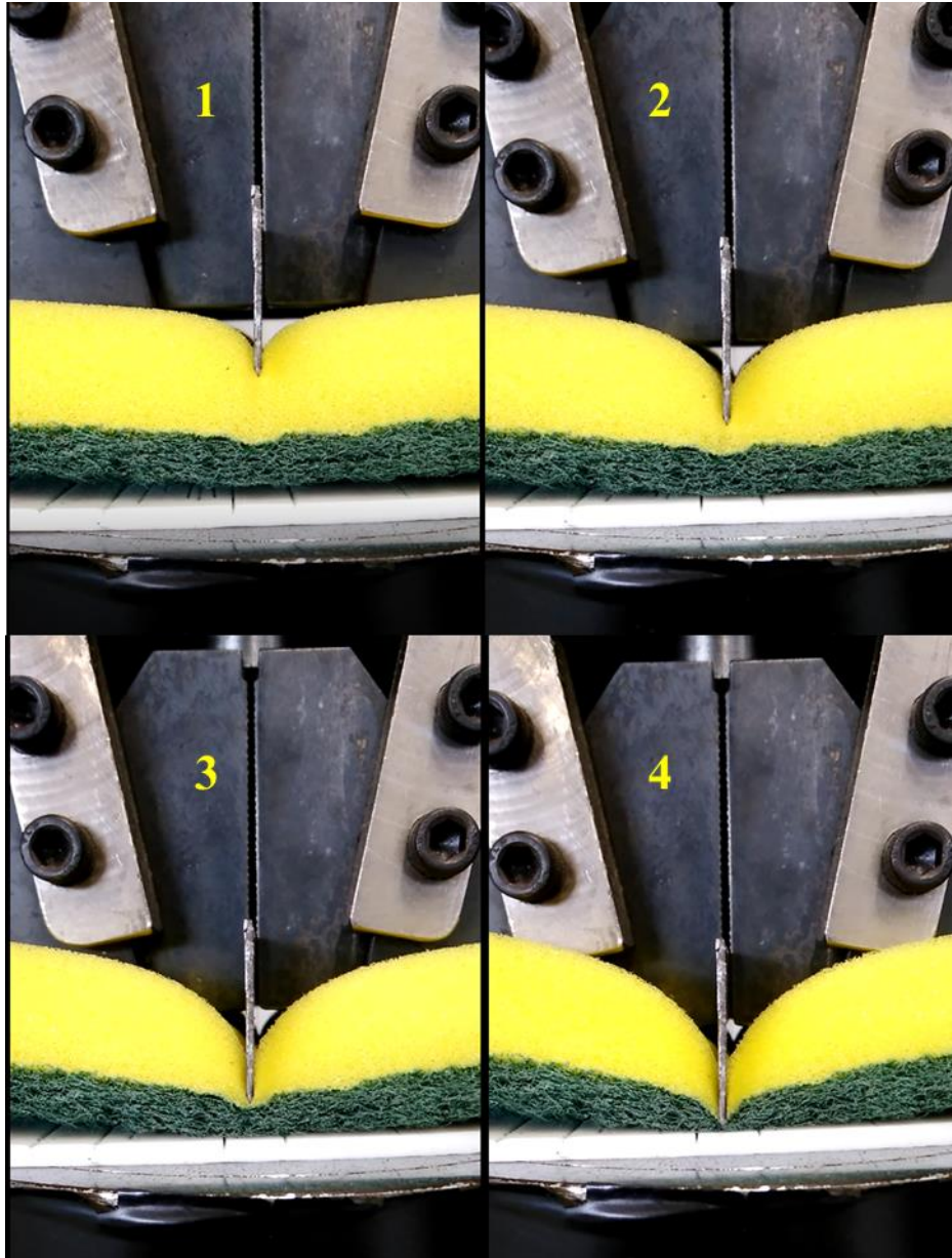
Figura 18: Imagens ao longo do tempo de um ensaio de força de corte. No momento 4 é quando o corte tem início. Fonte: Francisco Pereira Netto, 2016.
