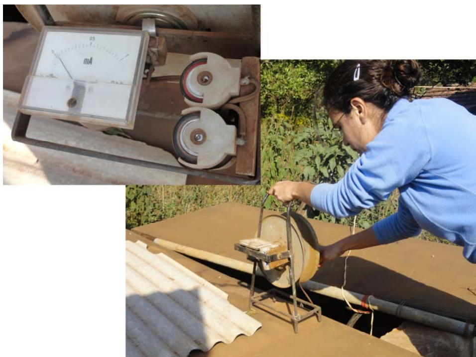
Figura 18: Instrumento para medição da profundidade dos poços com galvanômetro acoplado. (instrumento desenvolvido pelo técnico Antonio Garcia do laboratório de Geotecnia da Escola de engenharia de São Carlos da Universidade de São Paulo)
