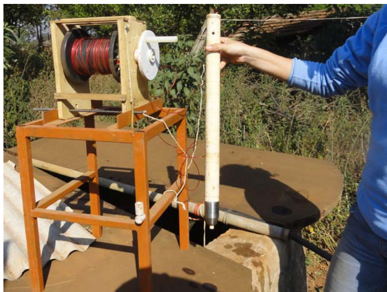
Figura 20: Instrumento para retirada de amostra dos poços (instrumento desenvolvido pelo técnico Antonio Garcia do laboratório de Geotecnia da Escola de engenharia de São Carlos da Universidade de São Paulo)
