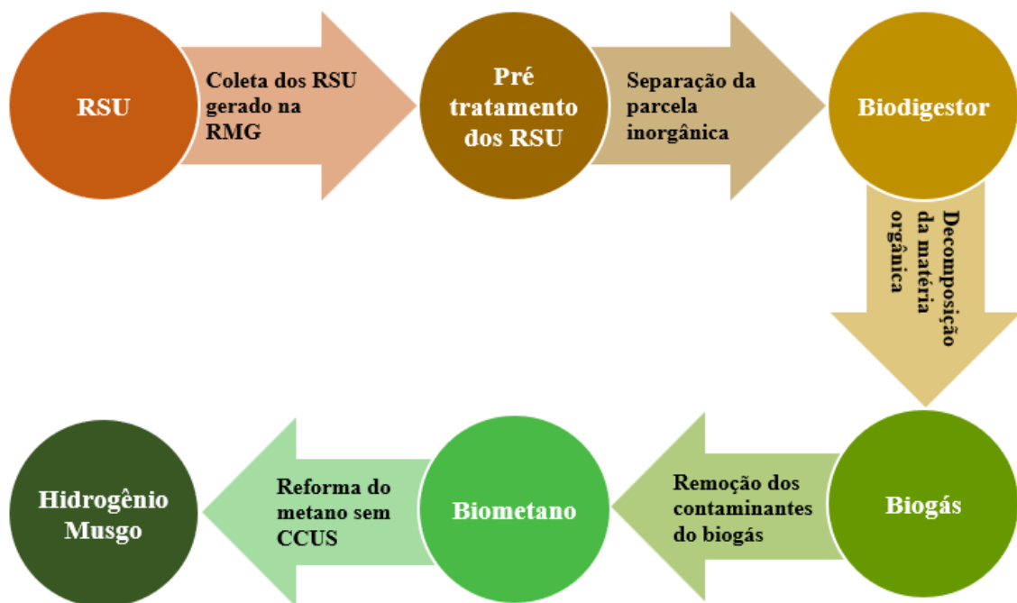
Figura 33: Fluxograma básico para obtenção do hidrogênio musgo
