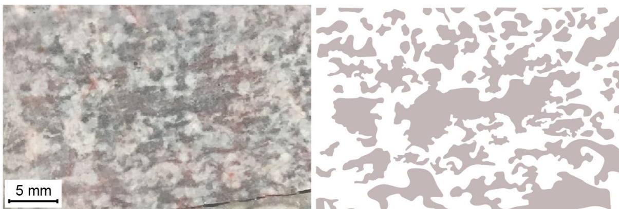
Figura 13 – Amostra de trombólito do testemunho de sondagem DD-003 (Anexo A, Figura A1), com desenho representativo dos grumos.
