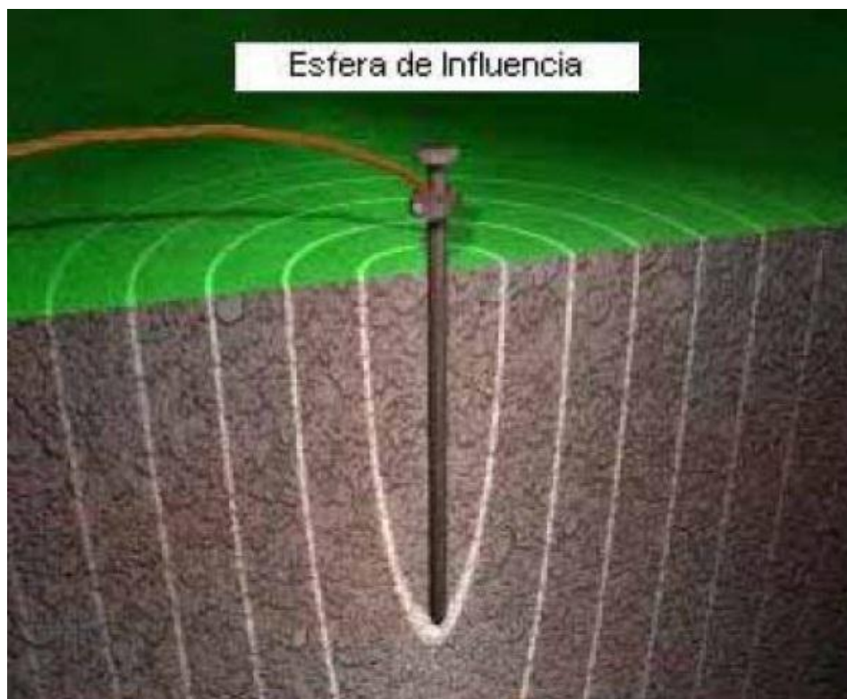
Figura 12 - Zona de influência de uma haste aterrada
