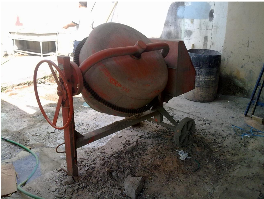
Figura 42 - Betoneira utilizada na produção
