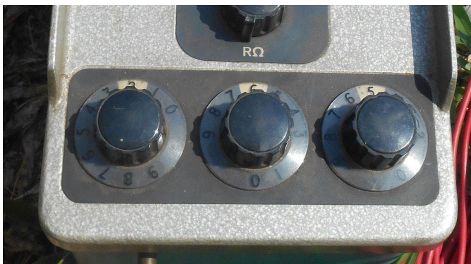
Figura 37 - Detalhe dos 3 botões indicadores do valor da resistência
