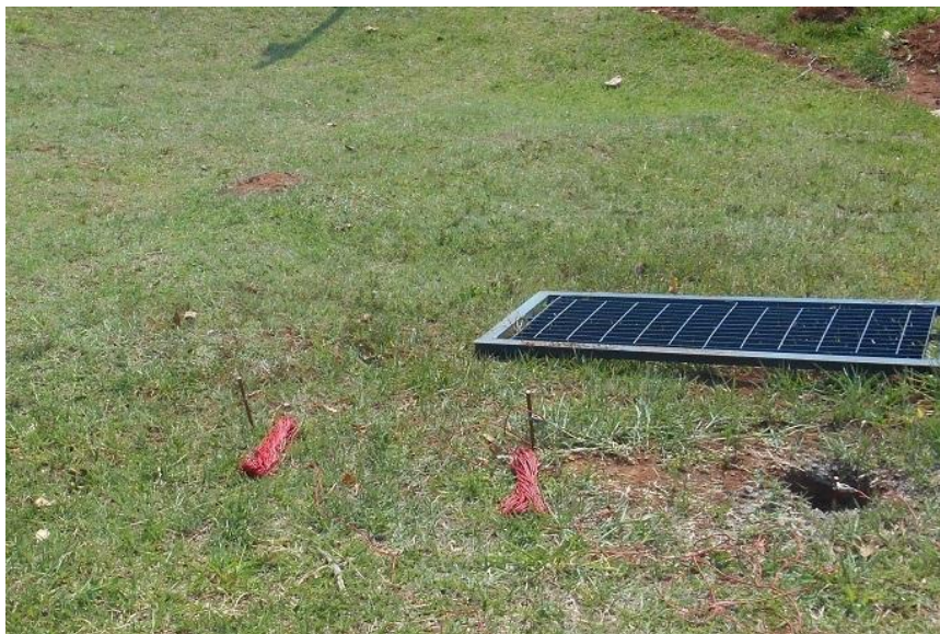
Figura 47 - Medição com L_1 = 2\text{ m} e L_2 = 4\text{ m}
