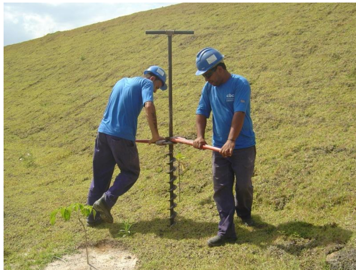
Figura 38 - Trado manual operado por duas pessoas que formam um binário de forças
