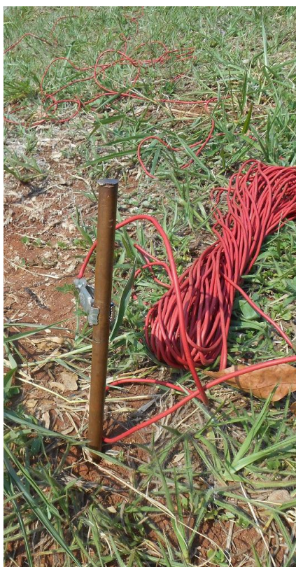
Figura 48 - Detalhe da conexão do fio ao eletrodo de potencial P2
