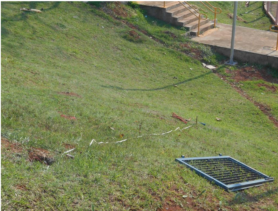
Figura 50 - Eletrodos com espaçamento de 3 m entre si, a 90° de distância das primeiras medições, na direção do campo de futebol
