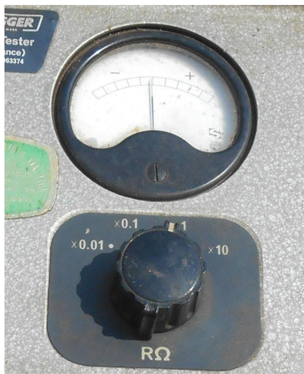
Figura 36 - Detalhe do botão multiplicador da escala
