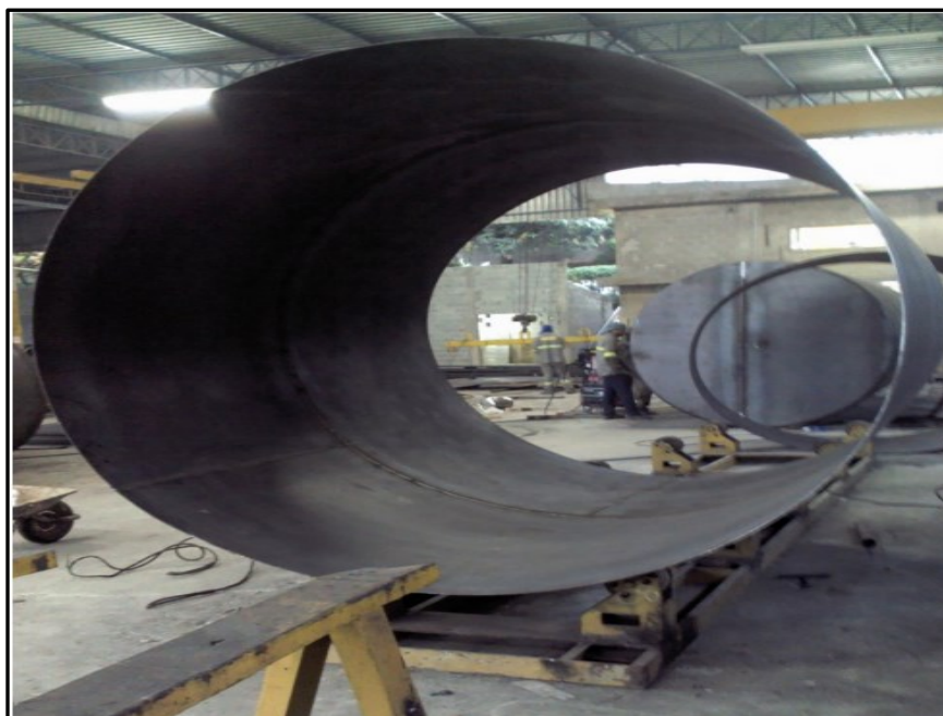
Figura 3- Tanque subterrâneo em aço em fabricação
