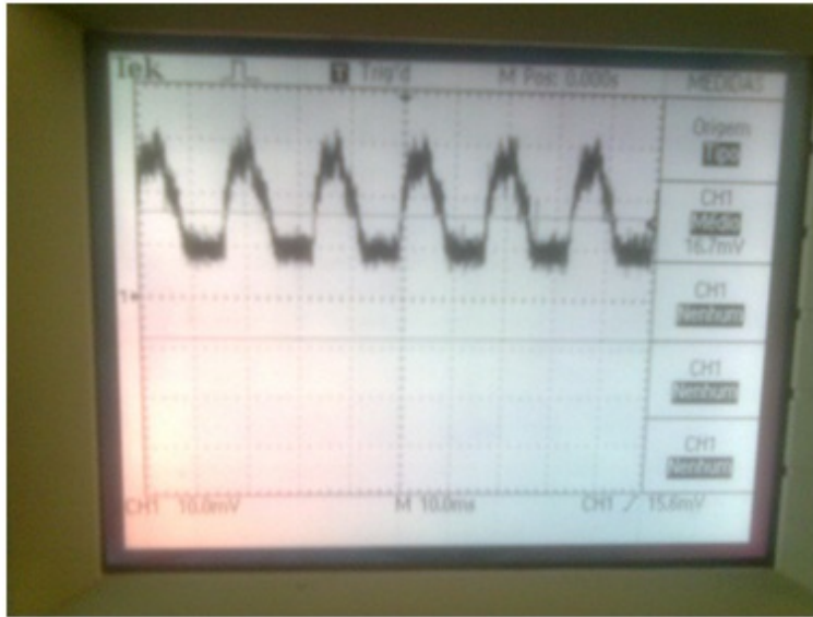
Figura 3.2: Flutuação do sistema (no escuro) medida no osciloscópio
