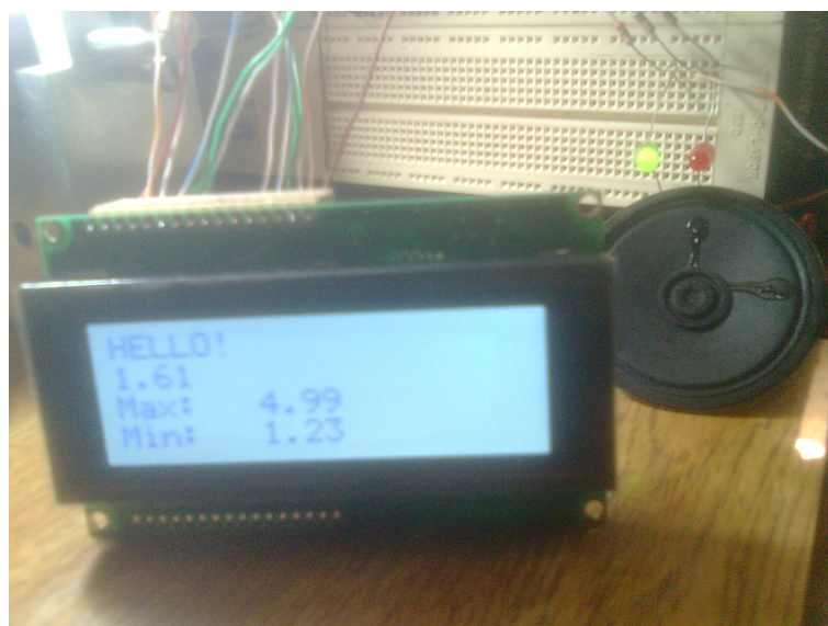
Figura 3.3: Exemplo de medição feita exibida na tela display, controlado pelo microcontrolador. Também na figura, os componentes de alerta (alto-falante e LED's)
