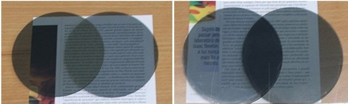
Figura 1.4: (a) Par de filtros polaróide com eixos de transmissão em posição paralela (mínima polarização) e; (b) perpendicular (máxima polarização) [Disponível em: < http://fisica.fe.up.pt/luz/polarizacao.html > Acesso em: 15 abr. 2011]
