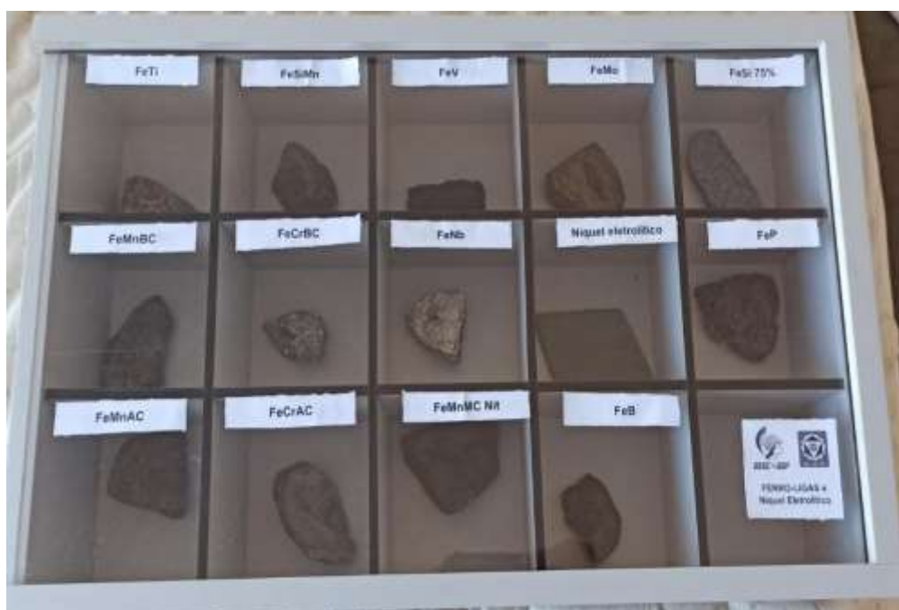
Fig 19: Caixa de Amostra com as ferroligas e níquel eletrolítico, já com o acrílico e identificados.
