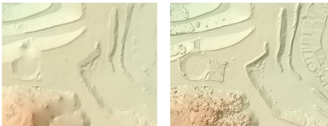
Figura 43 – Detalhe do MDT (esquerda) e MDS (direita), ambos com relevo sombreado, 13 de agosto.
