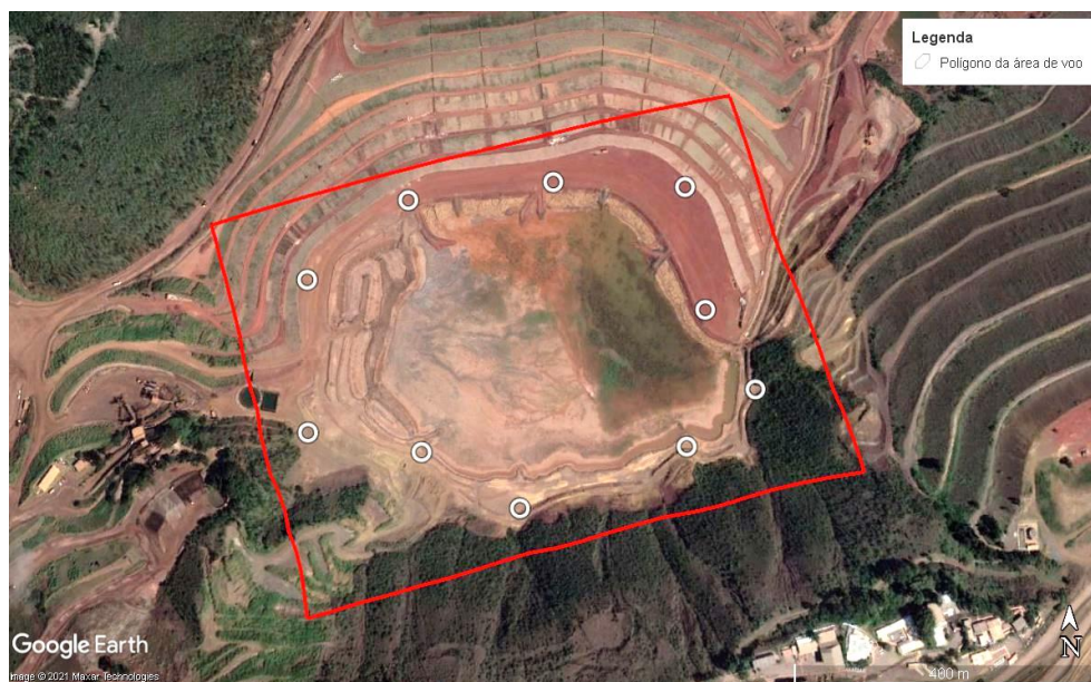
Figura 6 – Polígono editado no programa Google Earth Pro referente a área do aerolevanteamento com pontos de controle previamente demarcados.
