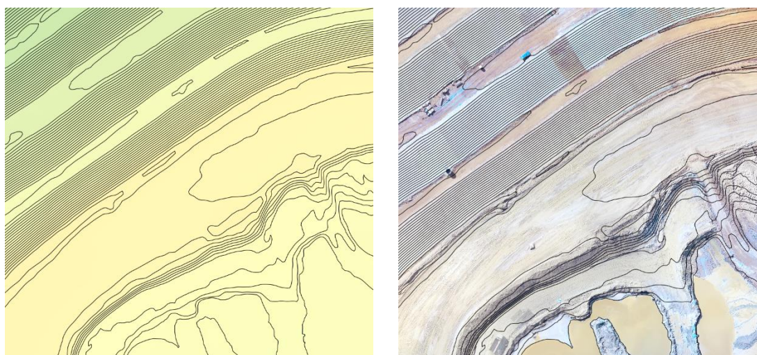
Figura 47 – MDT com curvas de nível (esquerda), ortomosaico com curvas de nível (direita). Ambos demonstram como as curvas de nível geradas são condizentes a declividade do modelo.
