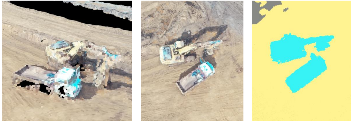
Figura 27 – Detalhe de escavadeira e caminhão, classificado como Human Made Object (Objeto de Fabricação Humana). Em amarelo o chão e cinza superfície da estrada.
