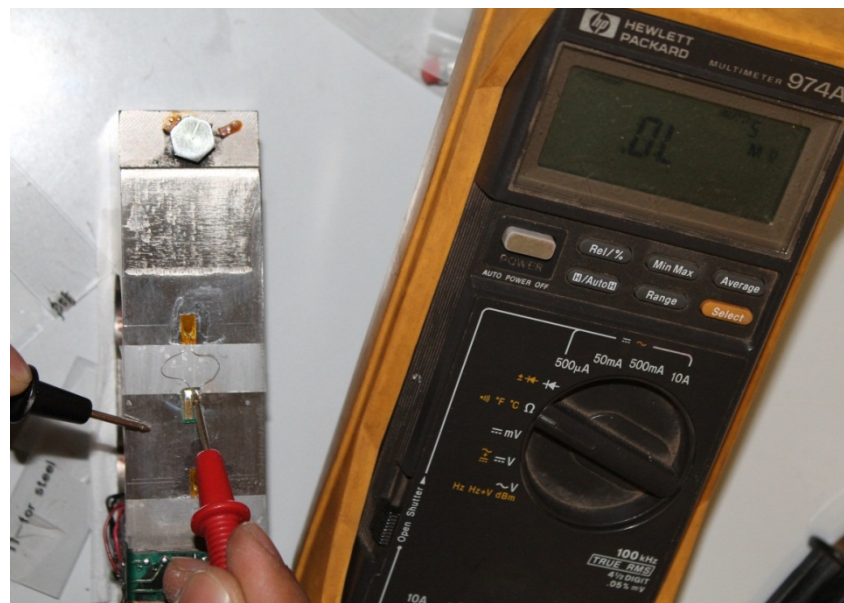
Figura 26: Medição da resistência de isolamento
