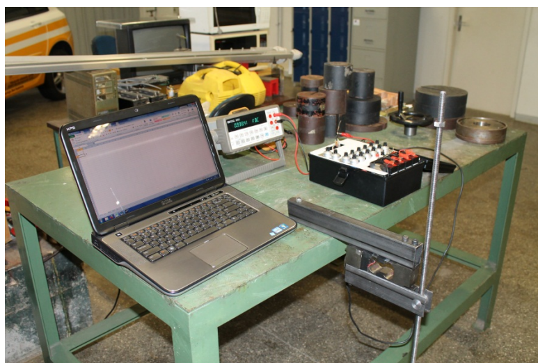
Figura 32: Montagem para calibração da célula de carga
