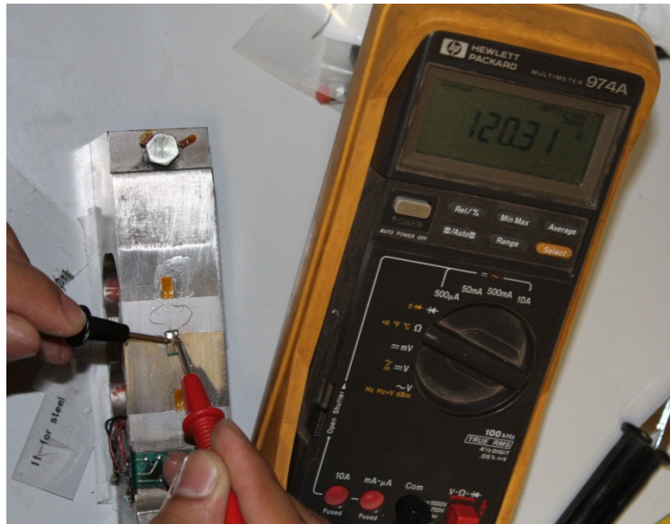
Figura 25: Verificação da resistência do extensômetro
