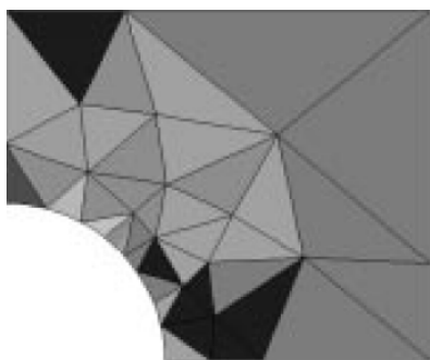
Figura A1: Tensões de von Mises em \frac{1}{4} de modelo tensionado utilizando elementos de primeira ordem
