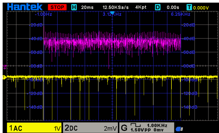
Figura 22 – Sinal após aplicação do optoacoplador
