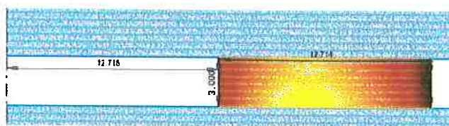
Figura F3 – Medida dos diâmetro do anel após simulação para condição ideal e temperatura 350°C
