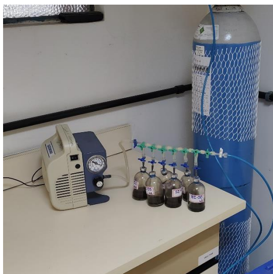
Figura 10. Degaseificação dos frascos com uso de bomba de evacuação e cilindro de gás nitrogênio.
