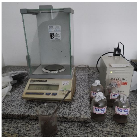
Figura 8. Pesagem de amostra em balança analítica e divisão da amostra moída e peneirada.
