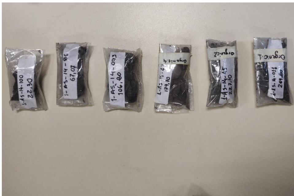
Figura 5. Pacotes de aproximadamente 8cm de largura e 30g de massa cada um, contendo as amostras de folhelho da Formação Solimões de diferentes profundidades da sondagem 1-AS-14-AM utilizadas para os experimentos de incubação.
