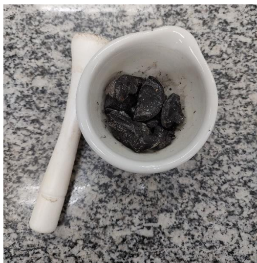
Figura 7. Amostra para moagem com uso de almofariz e pistilo.
