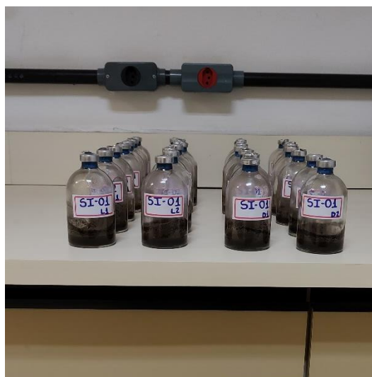
Figura 11. Amostras acondicionadas nos frascos para experimento de incubação.
