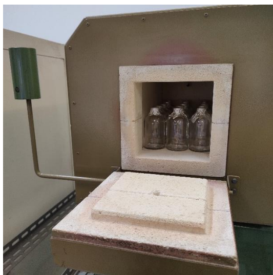
Figura 6. Vidrarias lavadas sendo calcinadas em forno tipo Mufla.
