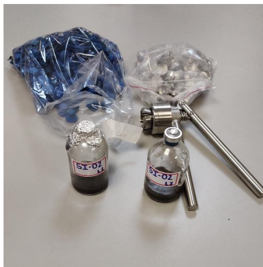
Figura 9. Selagem dos frascos com rolhas butílicas e lacres de alumínio.
