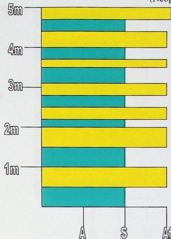
Figura 6: Coluna litoestratigráfica do afloramento do ponto 2. Amarelo: arenitos finos. Azul: siltitos.
