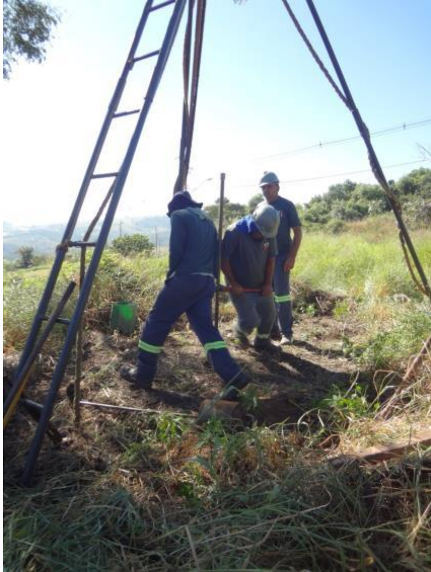
Figura 19: Sondagem - Detalhe da realização dos furos
