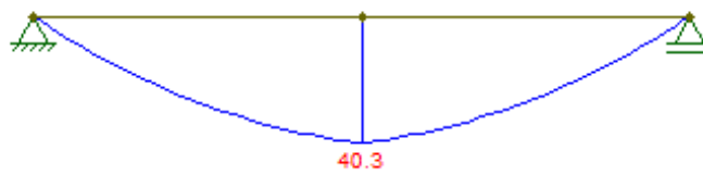
Figure 58 Diagramme de moment (cas de charge n°1 de la zone c)
