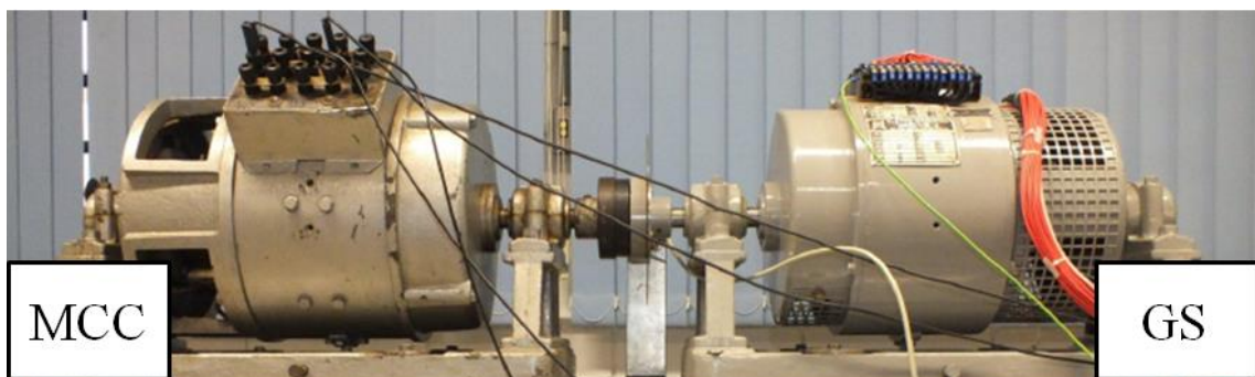
Figura 44 - Ligação entre as máquinas elétricas.
