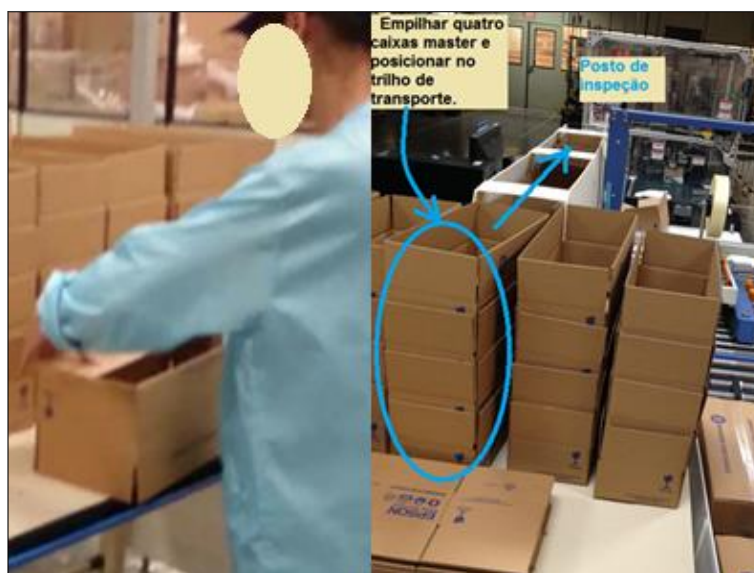
Figura 37 – Montagem da caixa máster
