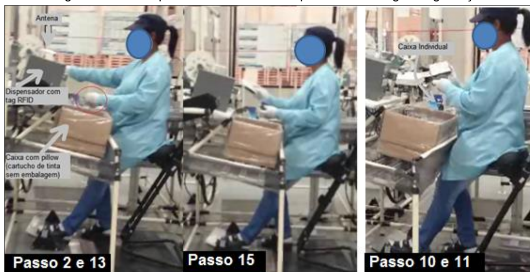
Figura 21 – Exemplos de movimentos do posto de montagem e gravação
