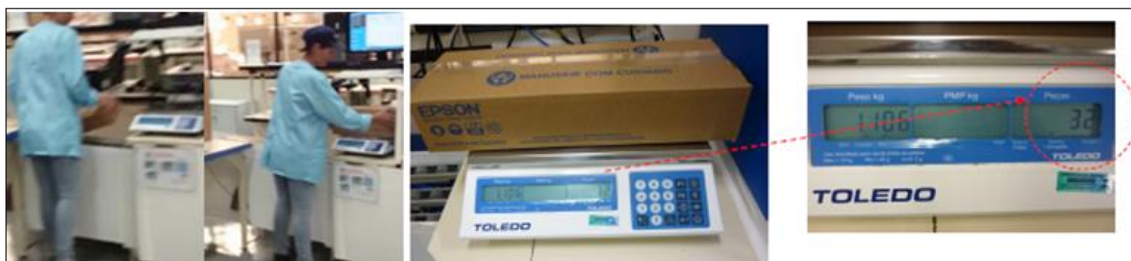
Figura 38 – Inspeção quantitativa da caixa máster
