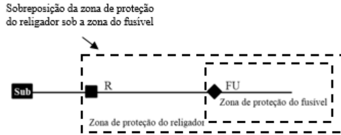
Figura 4: Coordenação entre fusível e religador
