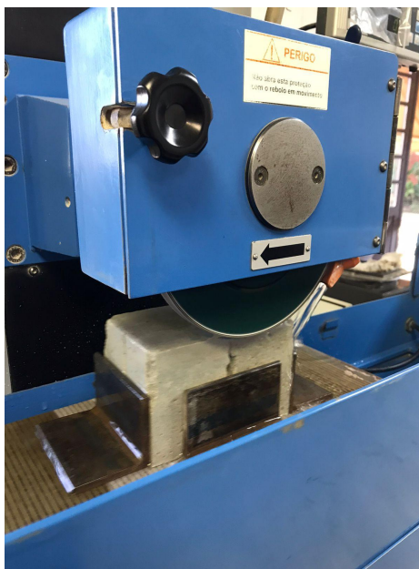
Figura 15- Retificadora Ferdimat TA60A usada na retificação dos corpos de prova
