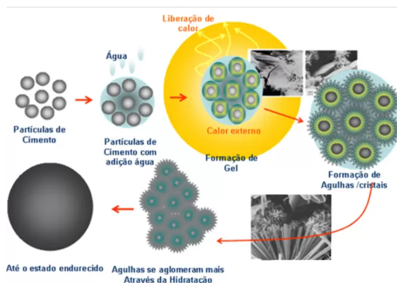
Figura 4 - Esquema de hidratação do cimento no processo de cura
