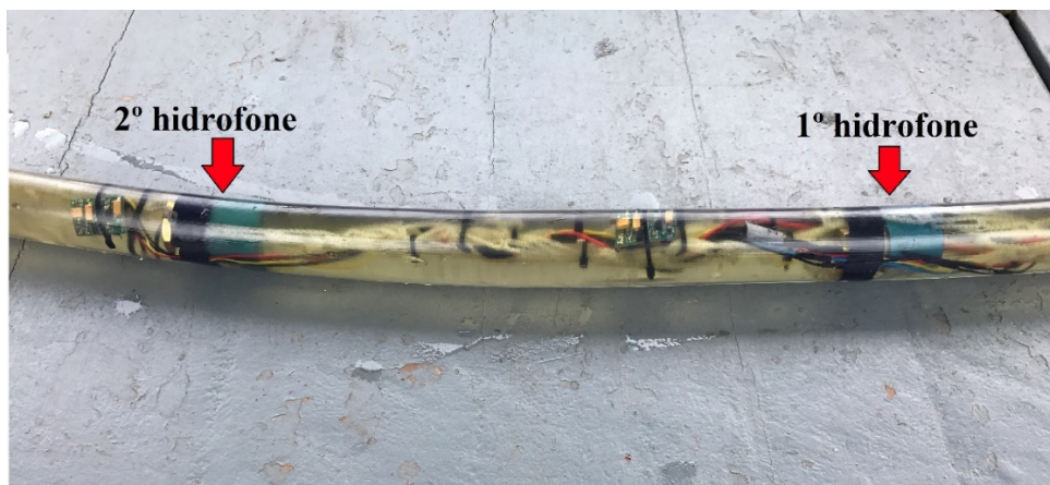
Figura 22 - Espaçamento entre os hidrofones
