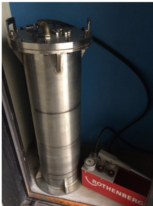
Figura 45 - Tanque para testes de estanqueidade
