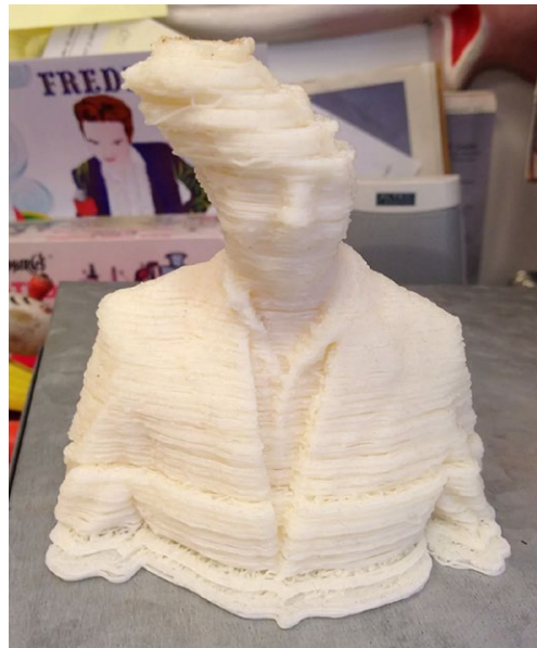
Figura 27. Exemplos de erros de impressão 3D esteticamente interessantes
