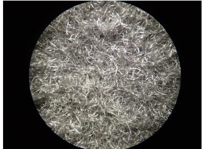
Figura 24: Geotêxtil de PP envelhecido por 1000 horas, ampliação de 5 vezes.
