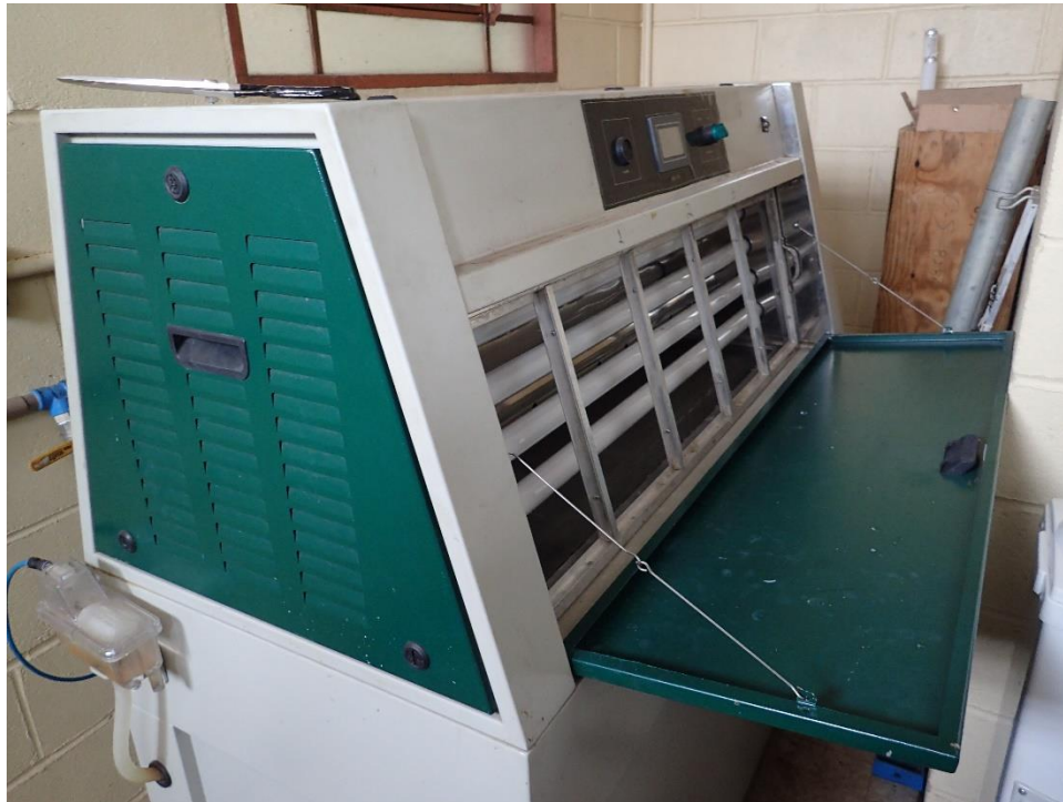
Figura 5: Câmara de envelhecimento UV
