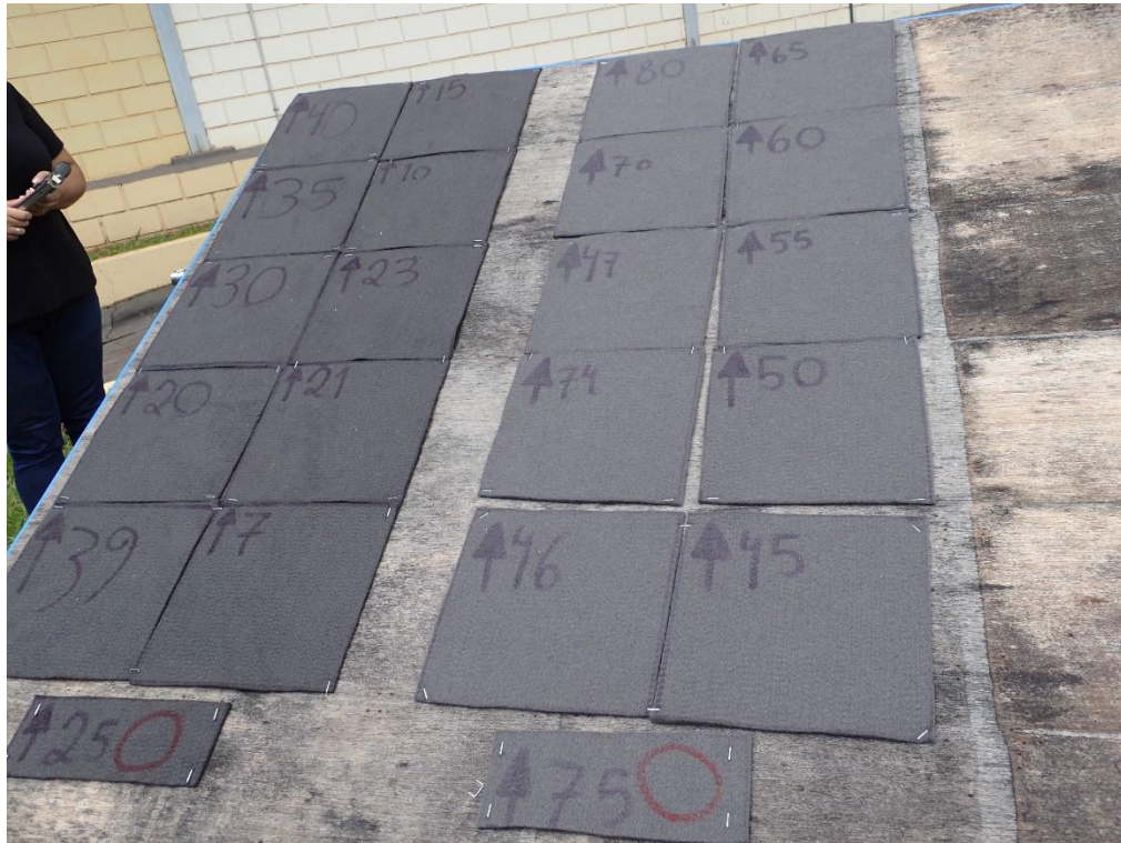
Figura 7: Subamostras expostas a intempéries.
