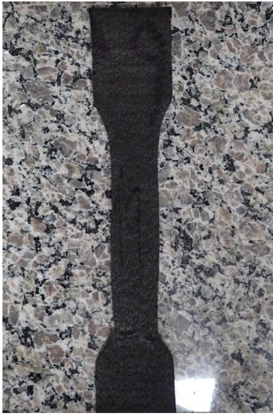
Figura 8: Estricção (estrangulamento) da parte do corpo de prova tracionado.
