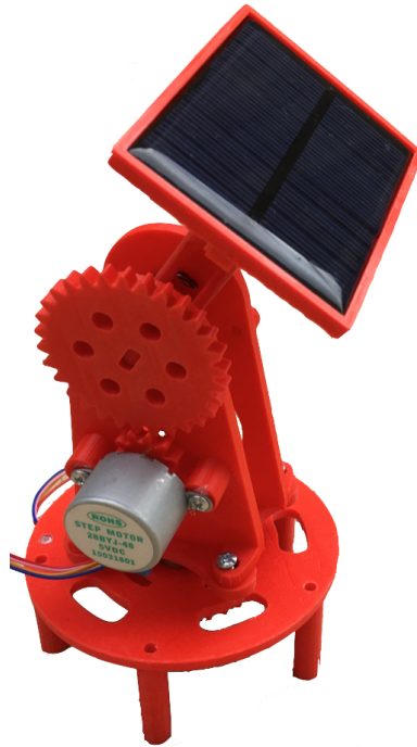
Figura 14 - Estrutura em PLA com os motores e o painel solar
