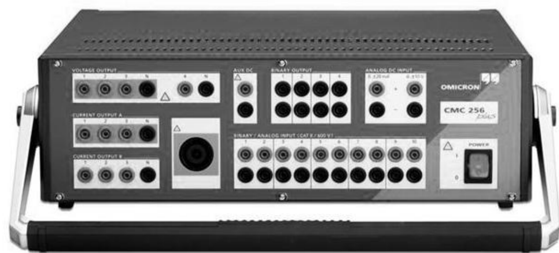
Figura 7 - Vista frontal da mala 256plus CMC do fabricante Omicron
