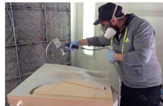
2- figura 03 – Aplicação de primer no molde (efeito impermeabilizante e protege a madeira de outros efeitos indesejados que a resina epoxy poderia causar, como corrosão)
