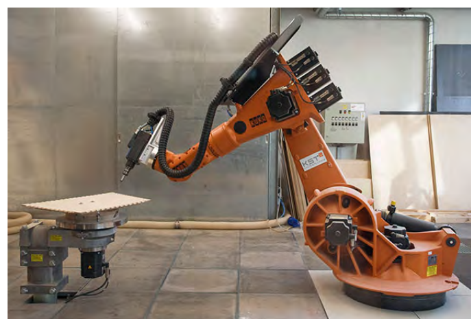
figura 13 – Máquina CNC 7 eixo
