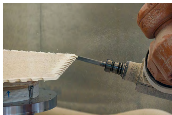
figura 14 – Máquina CNC 7 eixos (cortes de encaixe)
