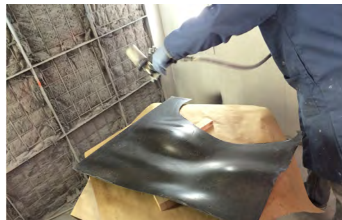
7- figura 10 – Aplicação da camada de brilho sobre a fibra as peças de fibra de carbono (aplicação depois de lixados as bordas e imperfeições das peças)
