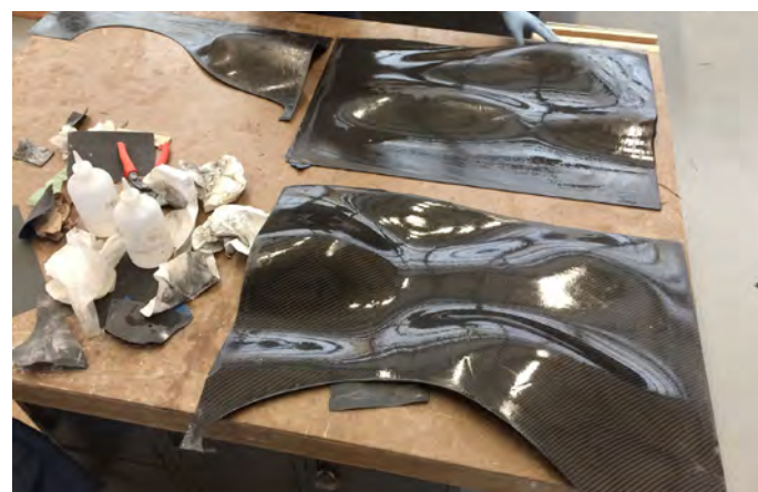
8- figura 09 – Peças finalizadas (montagem para furos e encaixes de parafusos)
