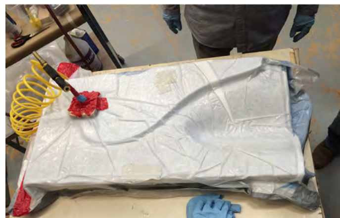
5- figura 06 – Molde embalado por um saco a vácuo e sucção de ar constante
