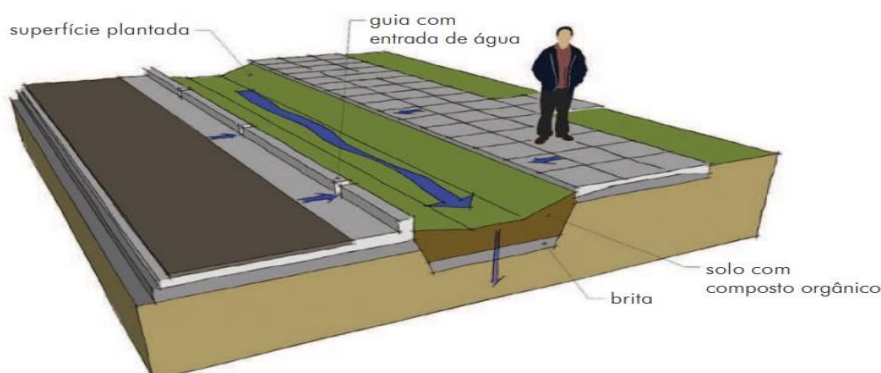
Figura 31. Esquema de uma biovaleta. Fonte: Cormier e Pellegrino (2008)
