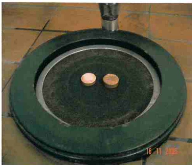
Figura 6: Politriz usada para o polimento das moedas de cobre
