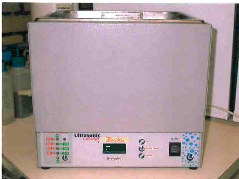
Figura 7: Equipamento de ultra-som para limpeza das moedas antes do teste
