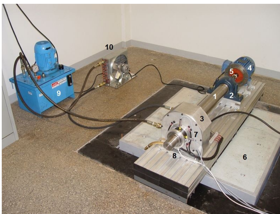
Figura 3: (1) eixo; (2) mancal de rolamentos autocompensador; (3) mancal hidrodinâmico segmentado com atuadores eletromagnéticos; (4) motor elétrico; (5) junta universal; (6) mesa inercial; (7) sensores de proximidade; (8) mancal auxiliar para excitação externa; (9) unidade hidráulica; (10) sistema de refrigeração
