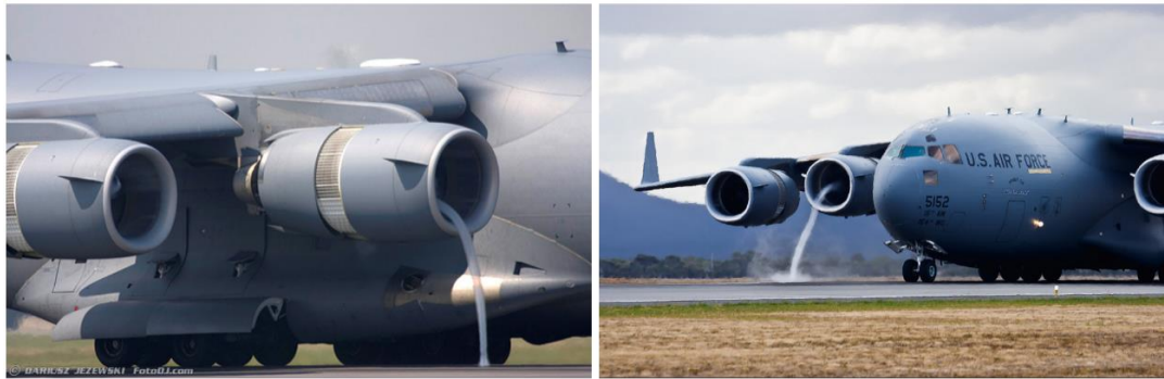
Figura 4. Inlet Vortex sendo succionado pelo motor em alta potência.
