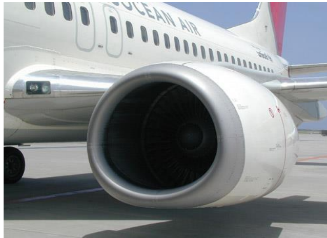
Figura 3. Nacele não-axisimétrica com raio variável entre diferentes posições circunferenciais.
