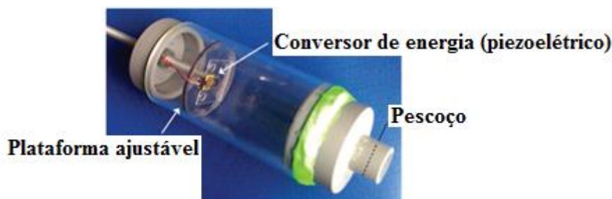
Figura 11 – Mecanismo para captação de energia utilizando ressonador de Helmholtz
