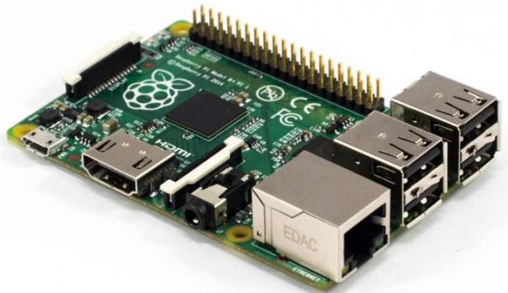
Figura 3 - Nova placa de aquisição - Raspberry pi B+
