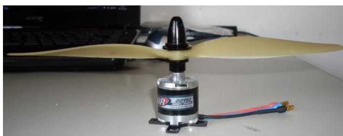
Figura 50 – Encaixe da hélice de aeromodelismo
