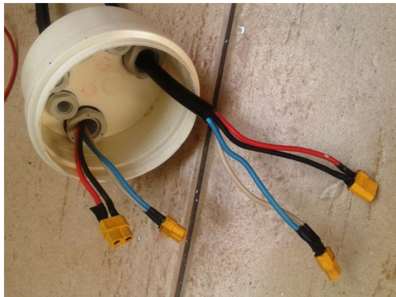
Figura 57 – Cabos finalizados com conectores
