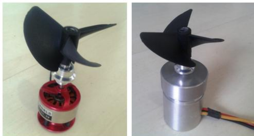
Figura 54 – Hélice acoplada ao motor sem e com o recipiente do motor
