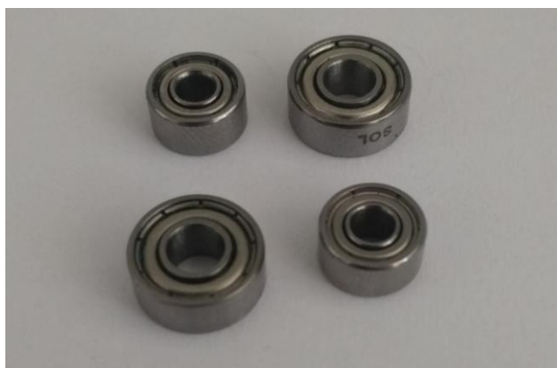
Figura 12 – Rolamentos para os motores
