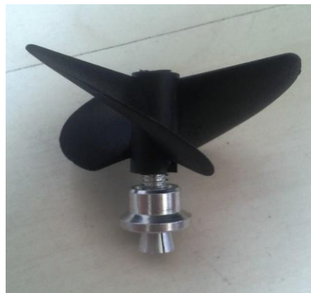
Figura 53 – Hélice conectada ao Spinner
