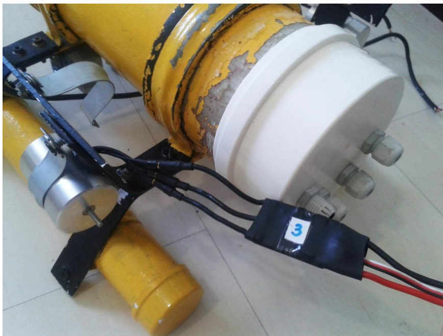
Figura 58 – Problema do comprimento dos fios do motor e ESC
