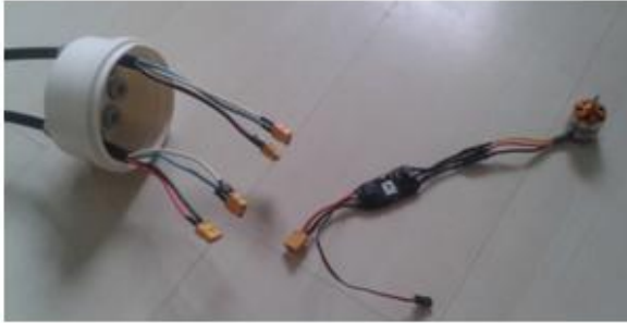
Figura 63 – Circuito Motor e Esc
