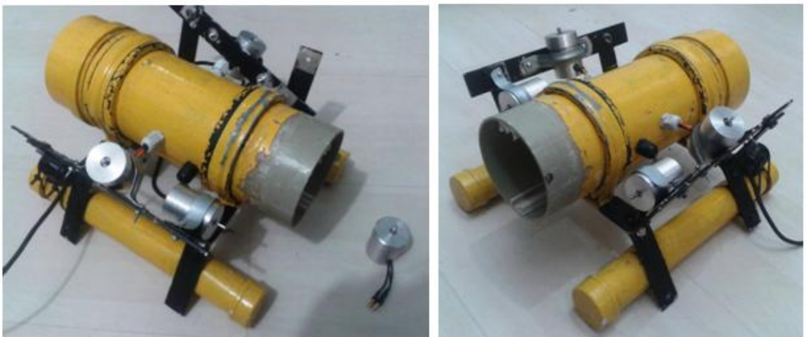
Figura 60 – Alocação dos motores
