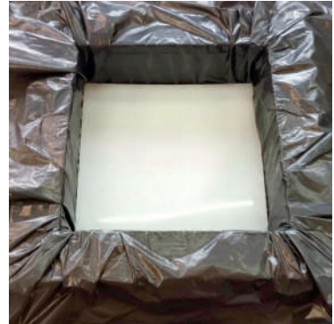
Figura 209 - Placa de polipropileno posicionada sobre as fibras
