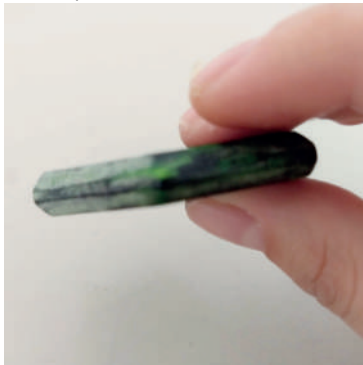
Figura 259 - Peça parcialmente com cera de abelha aplicada
