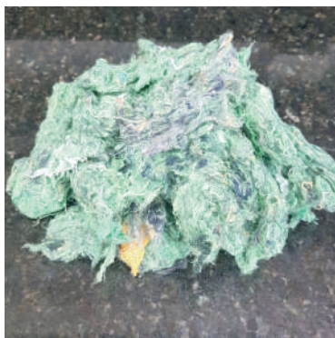
Figura 17 - Fibra têxtil desfibrada proveniente de uniformes de empresas particulares
