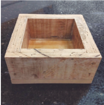
Figuras 68 e 69 - Molde e contra-molde após as alterações
