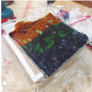
Figura 112 - Amostra após prensagem e desmoldagem ainda com rebarbas
