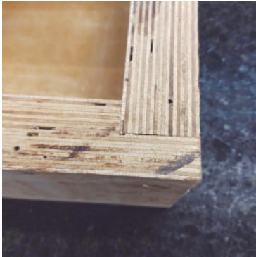
Figura 70 - Detalhamento das paredes reforçadas do molde
