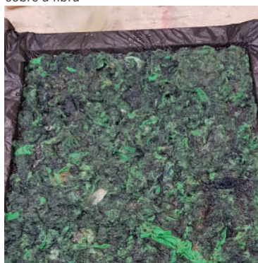
Figura 60 - Molde com resina aplicada sobre a fibra
