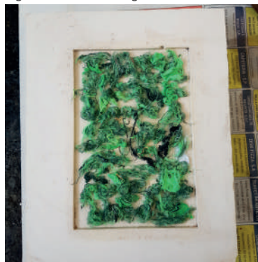
Figura 40 - Molde de gesso com fibra textil
