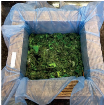
Figura 94 - Fibras embebidas posicionadas no molde
