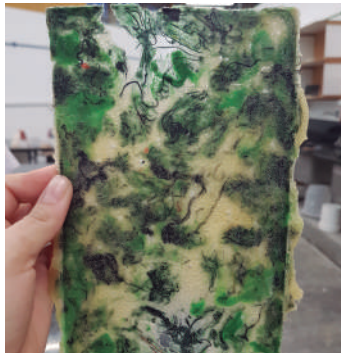
Figura 46 - Amostra após a cura e desmoldagem
