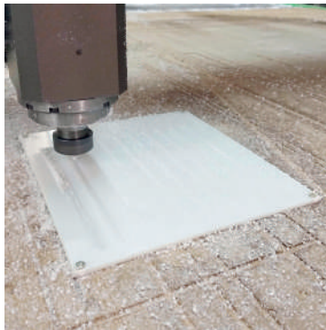
Figura 205 - Placa de PP sendo usinada
