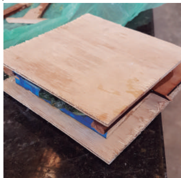
Figura 36 - Resina de mamona e fibra prensada com madeira
