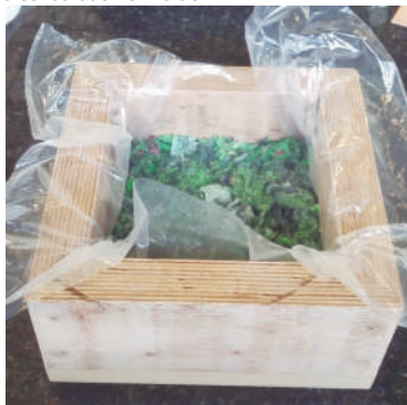
Figura 79 - Fibras já embebidas em resina distribuídas no molde
