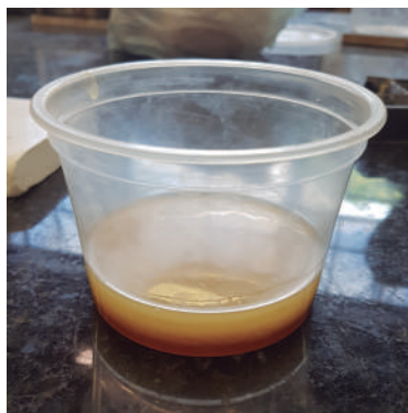
Figura 26 - Resina bicomponente de mamonha antes de ser misturada (125g)
