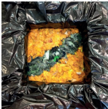
Figura 162 - Fibras embebidas dispostas no molde formando o padrão desejada peça
