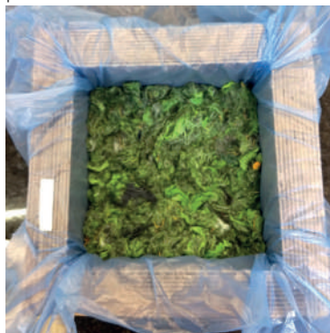
Figura 87 - Fibras embebidas em resina posicionadas no molde
