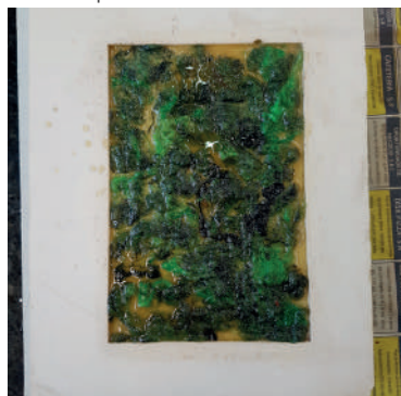
Figura 42 - Molde de gesso com fibra têxtil e resina aplicada
