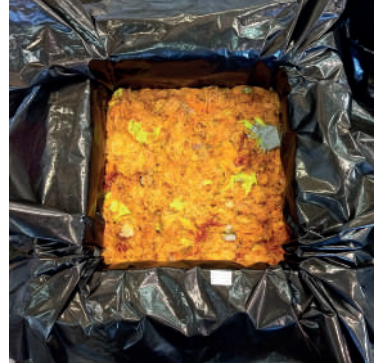
Figura 103 - Molde com fibras embebidas distribuídas
