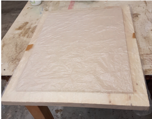
Figura 51 - Contra molde forrado com plástico
