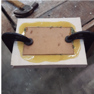
Figura 44 - Amostra de prova prensado aguardando cura da resina
