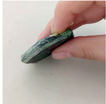
Figura 260 - Lateral de amostra com aplicação de cera de abelha
