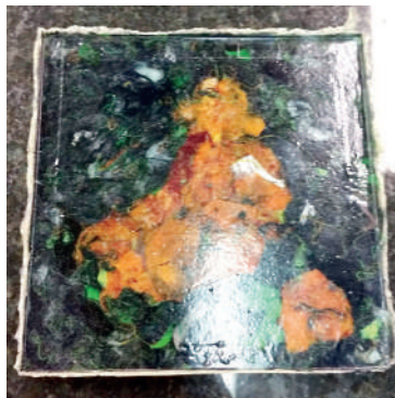
Figura 185 - Amostra retirada do molde ainda com rebarbas
