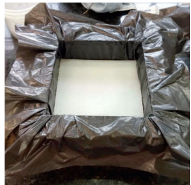
Figura 219- Placa de polipropileno posicionada sobre as fibras
