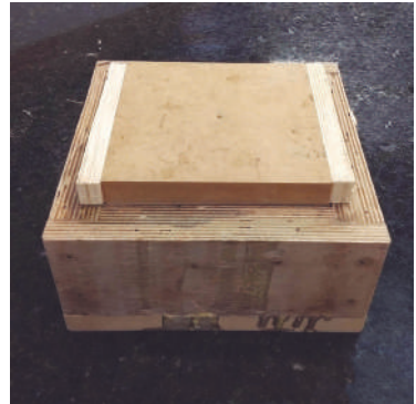
Figura 71 - Contra-molde posicionado no molde
