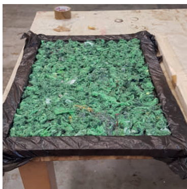
Figura 59 - Molde com desfibrado têxtil
