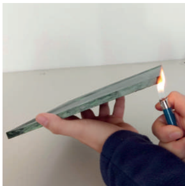
Figura 279 - Amostra recebendo ação de chama
