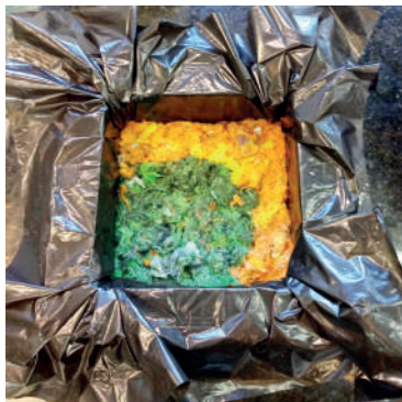
Figura 128 - Fibras embebidas dispostas no molde
