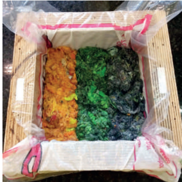
Figura 110 - Fibras dispostas no molde em faixas verticais
