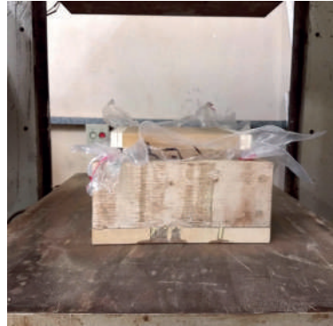
Figura 111 - Molde posicionado na prensa
