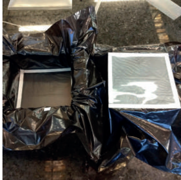
Figura 102 - Molde e contra molde preparados para a disposição das fibras
