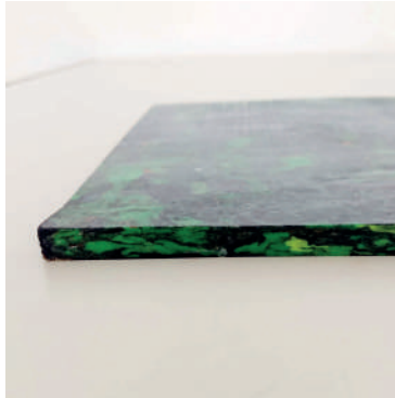
Figura 249 - Óleo de rícino aplicado nas laterais da amostra
