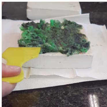
Figura 27 - Aplicação da resina de mamona sobre a fibra
