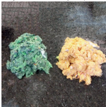
Figura 127 - Fibras desfibradas verde e laranja utilizadas na confecção da placa
