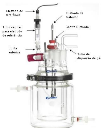
Figura 3 - Foto de uma montagem padrão dos equipamentos de um teste eletroquímico com célula da marca Gamry. Fonte Adaptado: UNDHEIM (2021)
