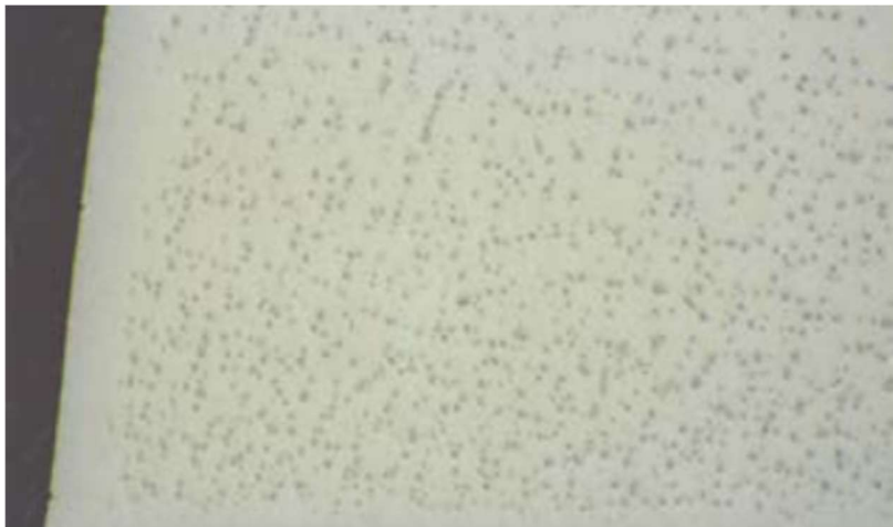
Figura 41 - Titânio após polimento em diamante de 3 µm em que a deformação e riscos não foram removidos [23].
