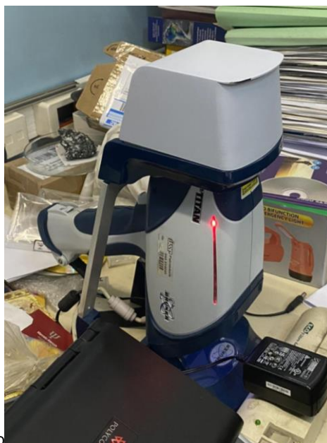
b) Analisador Bruker S1 Titan utilizado para análise química de FRX. Foto: Giovanni Bueno de Oliveira em 10/10/2022.
