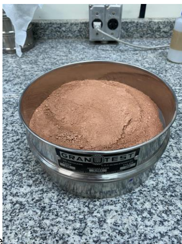
e) Peneira de abertura de 0,063mm; f) Mesa vibratória para peneiramento e g) Frações de silte e argila peneiradas.
