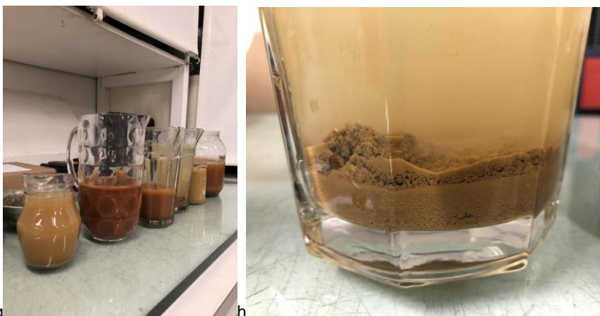
e) Processo de filtragem do solo; f) Processo de decantação; g) Diferentes solos coletados passando por decantação e h) Fração argila do solo decantada. Fotos: Giovanni Bueno de Oliveira em 04/06/2022.
