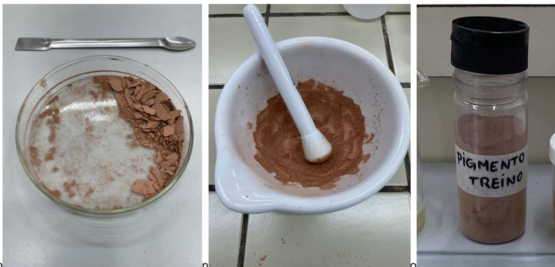
m) Material seco e fragmentado; n) Moagem dos pigmentos e o) Pigmento do solo de treino extraído.
