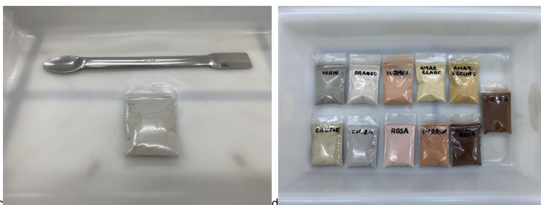
c) Amostra de argila pós moagem e d) Amostras dos solos encaminhados para DRX. Fotos: Giovanni Bueno de Oliveira.
