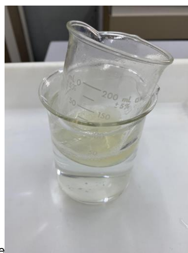
c) Mistura de água destilada com goma arábica; d) Adição de vinagre à mistura e e) Solução aquecida por banho-maria.
