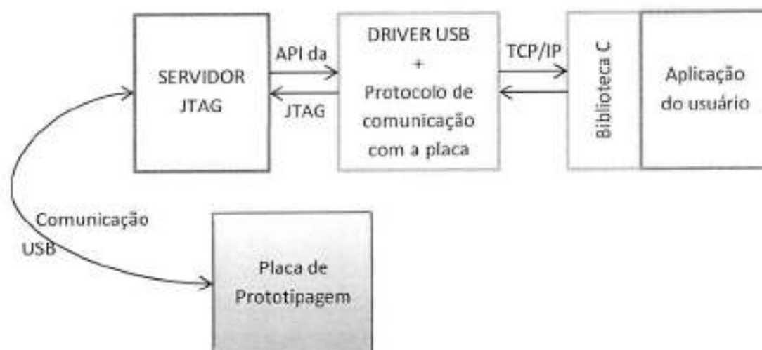
Figura 29. Diagrama de blocos do Driver USB e suas interações
