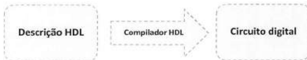
Figura 1. A síntese do circuito digital a partir da descrição HDL é de responsabilidade do compilador
