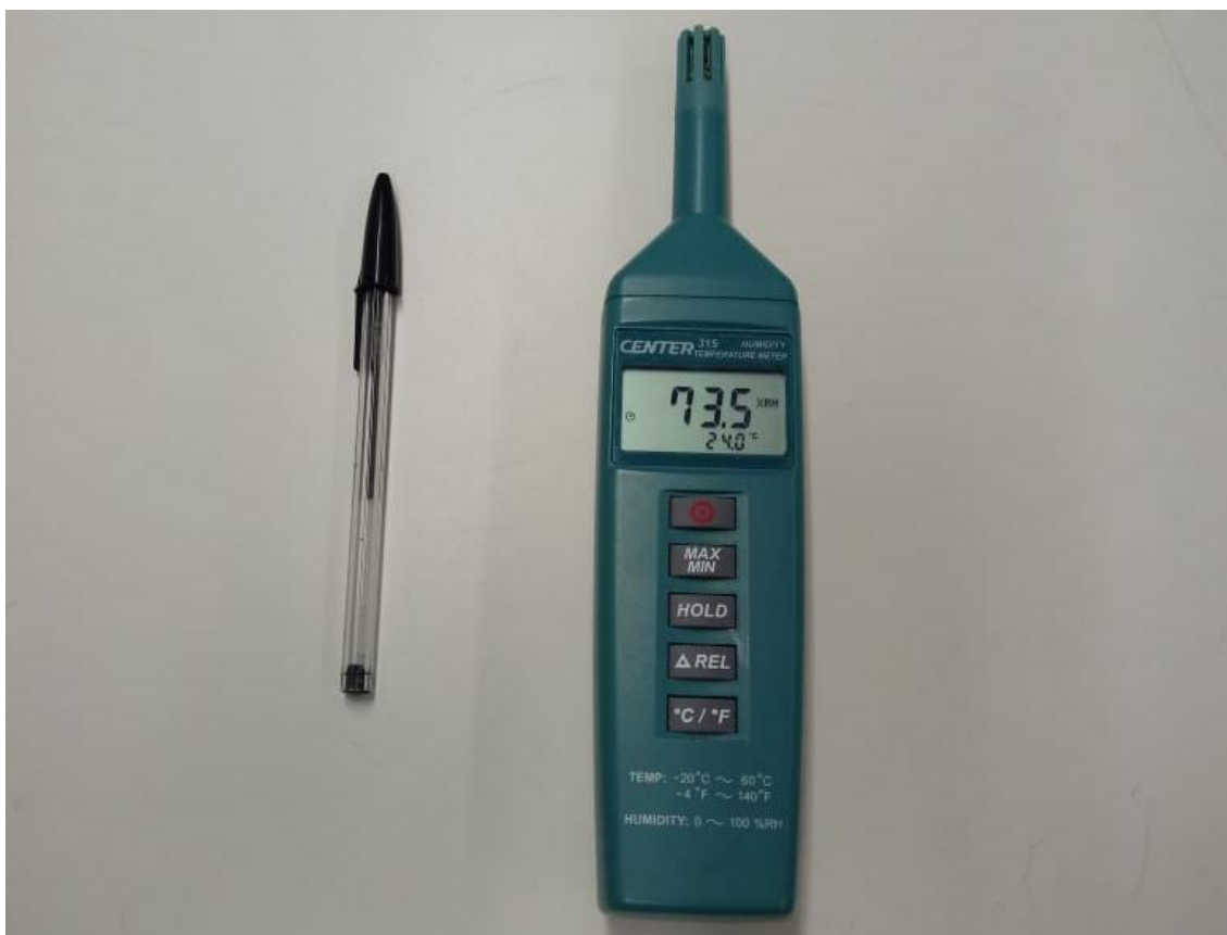
Imagem 4. Termohigrômetro digital de leitura direta utilizado para coleta de Temperatura e Umidade Relativa do Ar. Imagem de autoria do Laboratório de Climatologia e Biogeografia do DG-USP.
