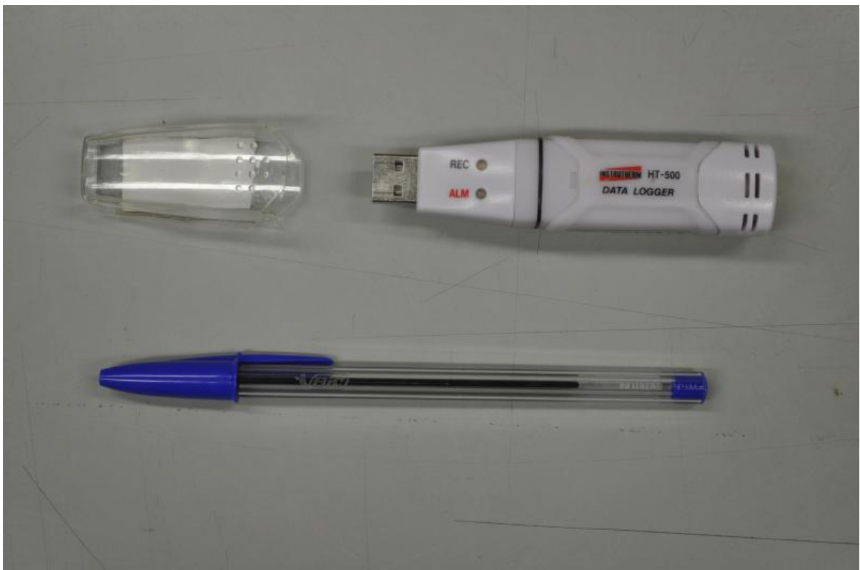
Imagem 3. Modelo do Data Logger utilizado para coleta de Temperatura e Umidade Relativa do Ar. Imagem de autoria do Laboratório de Climatologia e Biogeografia do DG-USP.
