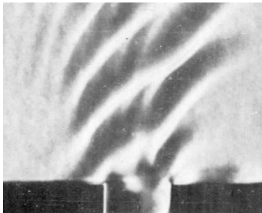
Figura 2 – Fotografia de ondas acústicas emitidas por uma cavidade retangular. Visualização produzida utilizando técnica Schlieren
