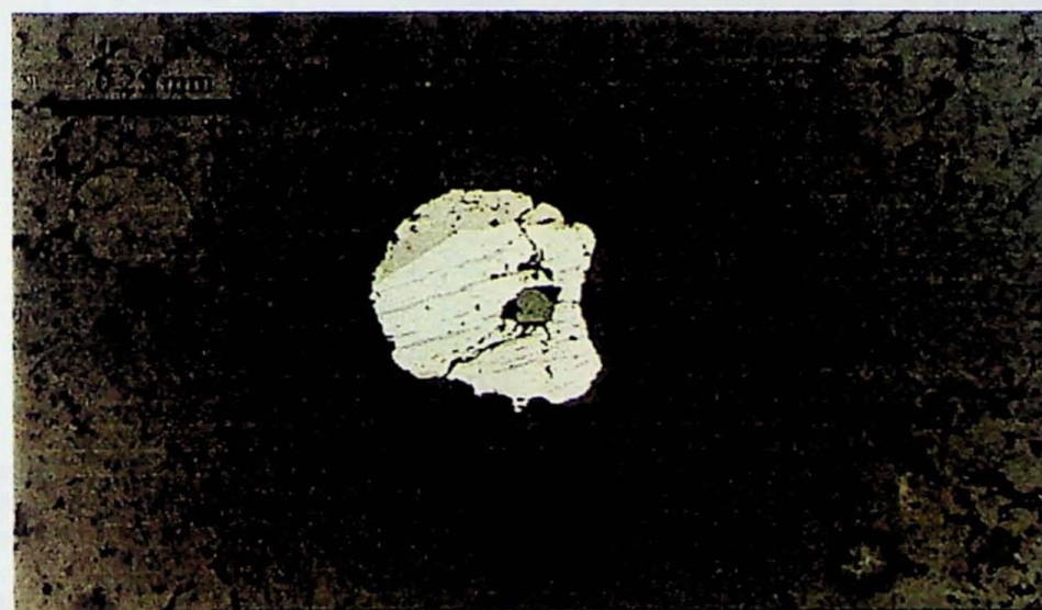
Fotomicrografia 12. Granito porfírico com muscovita e biotita, maciço Piedade. Amostra PD 462. Luz refletida. Grão isolado de hematita, com lamelas de ilmenita.
