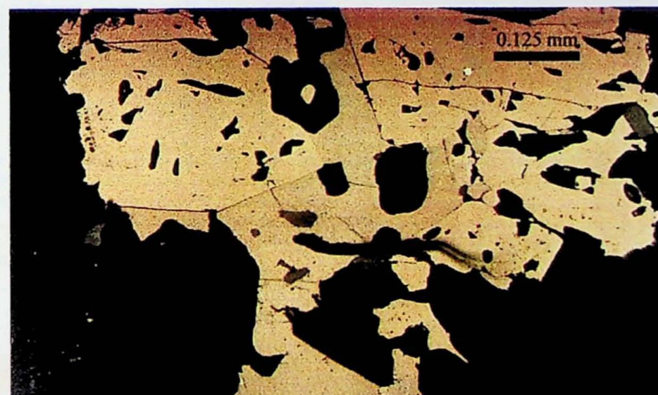
Fotomicrografia 18. Granito com biotita, maciço Cantareira. Amostra Ca 13. Luz refletida. Observar grão irregular de ilmenita, ao centro, em contato com grão idiomórfico de magnetita, à esquerda e direita.
