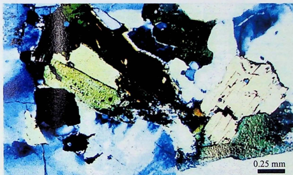
Fotomicrografia 17. Aspectos texturais em granito inequigranular-porfírico com biotita, maciço Cantareira. Amostra Ca 13. Luz transmitida, polarizadores cruzados. Observar deformação e fraturas em biotita.
