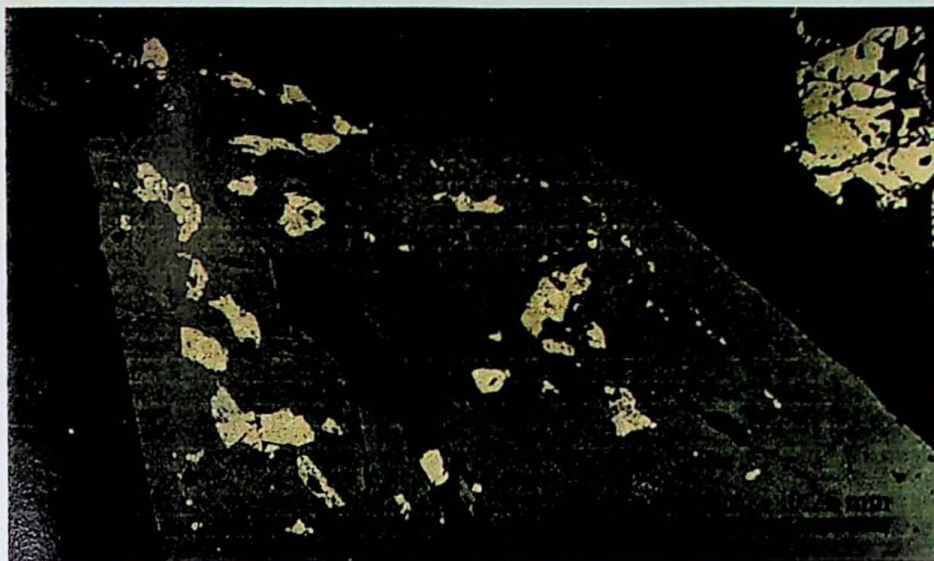
Fotomicrografia 16. Granito porfírico com biotita, maciço Taipas (mesma amostra da Fotomicrografia anterior). Luz refletida. Titanita idiomórfica com inclusões de hematita e ilmenita.
