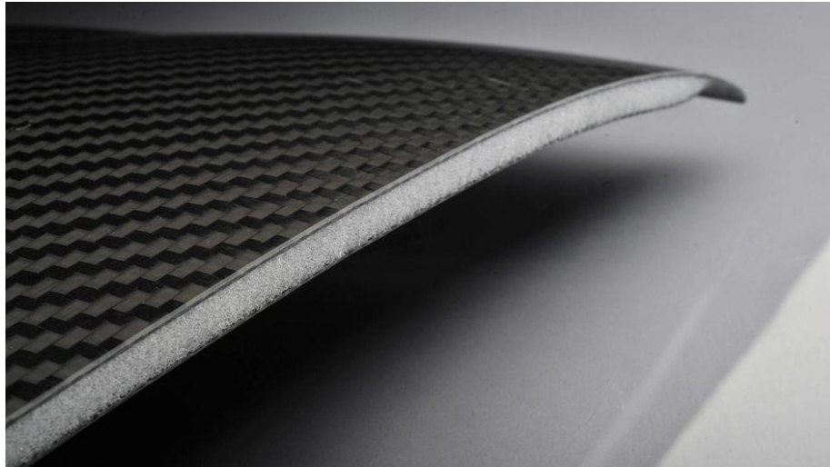
Figura 8 - Estrutura sanduíche de fibra de carbono e núcleo de PMI (Rohacell IG-F®).
