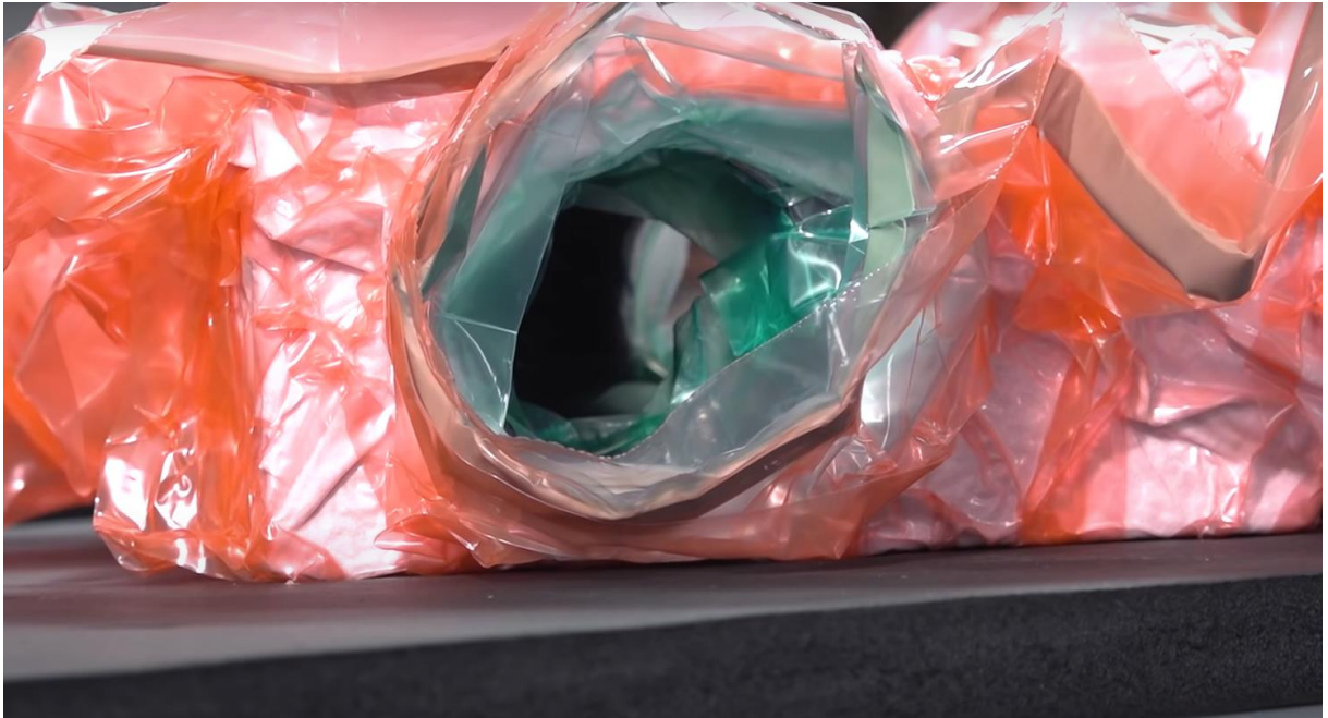
Figura 17 - Método de vácuo utilizando uma bolsa externa (vedada) e uma bolsa interna ao tubo (vazada).
