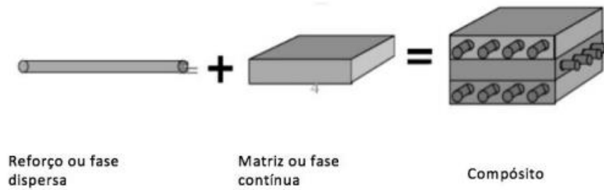
Figura 6 - Constituintes de um material compósito.
