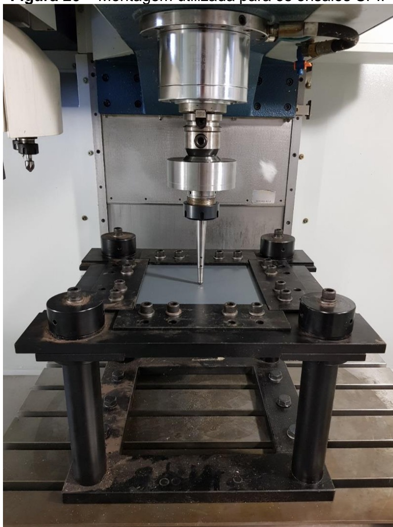
Figura 20 – Montagem utilizada para os ensaios SPIF
